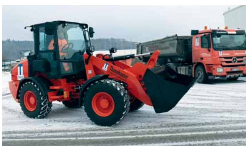
Unverzichtbar auf den Baustellen und dort wegen seiner Vielseitigkeit nicht wegzudenken ist der kompakte Radlader wie der Cat 908.
